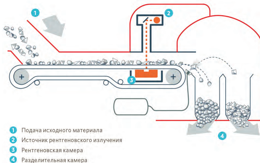
Рис. 2. Схема работы сепаратора TOMRA Sorting GmbH
