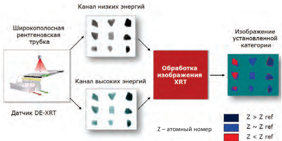
Рис. 2. Результат работы ЭВМ сепаратора TOMRA Sorting
