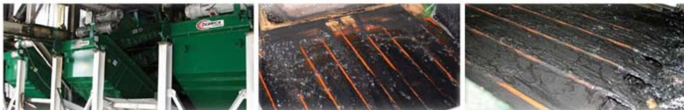
Рис. 2. Три грохота Stack Sizer™ на фабрике White County Preparation Alliance Coal Company и полиуретановые панели в работе
