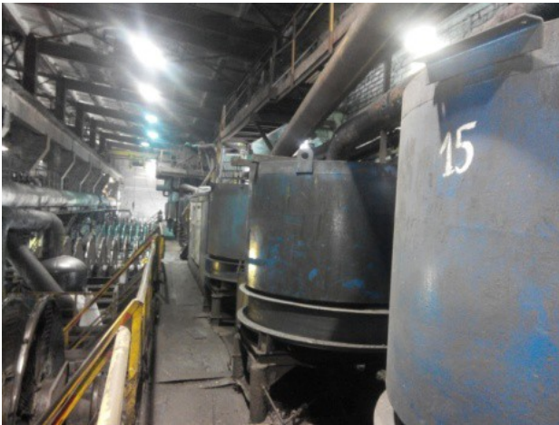
Рис. 5. Общий вид стадии магнитно-гравитационных сепараторов (ЭМС-150) на ДОФ АО «Олкон»
