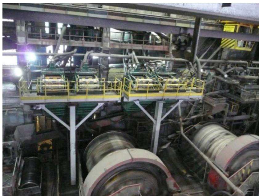
Рис. 1. Общий вид грохотов «Stack Sizer ™ » корпорации «Derrick Corporation» на ДОФ АО «Олкон»
